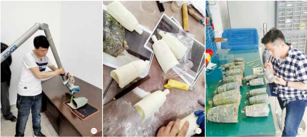
01 3D 数据扫描 02 3D 打印成形 03 表面作色做旧 04/05 复制件展示
